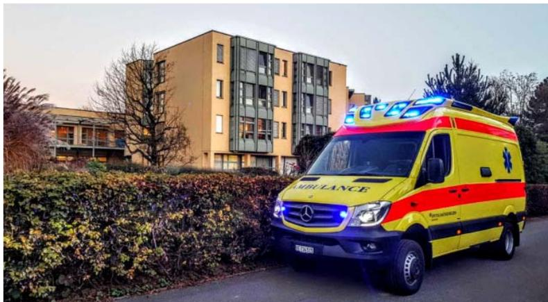
Neu verfügt das Fahrzeug über Allradantrieb. Dies erhöht die Sicherheit im Winter und ermöglicht uns, höher gelegene Orte besser zu erreichen sowie unwegsames Gelände zu überwinden. Beim Stand der Ausrüstung fehlt es dem neuen Fahrzeug an nichts. Das bewährte Konzept seines Vorgängers wurde hier weiterentwickelt und verbessert. Der Rettungswagen entspricht der Norm EN1789, welche in der Schweiz
